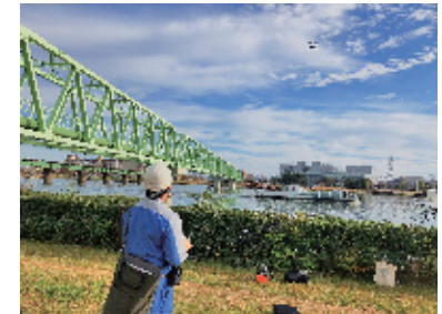
新潟県の水管橋調査にて、 ドローンを活用する当社エンジニア
